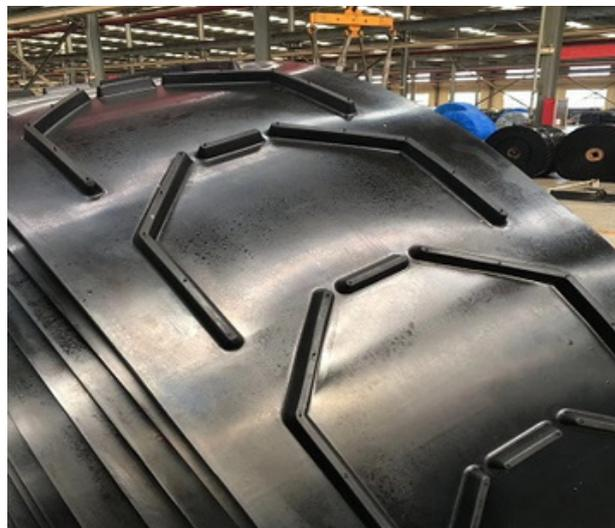
La cinta transportadora Chevron es adecuada para transportar materiales accionados, granulados, en grumos o embolsados en superficies inclinadas con ángulos de no más de 40 grados.
