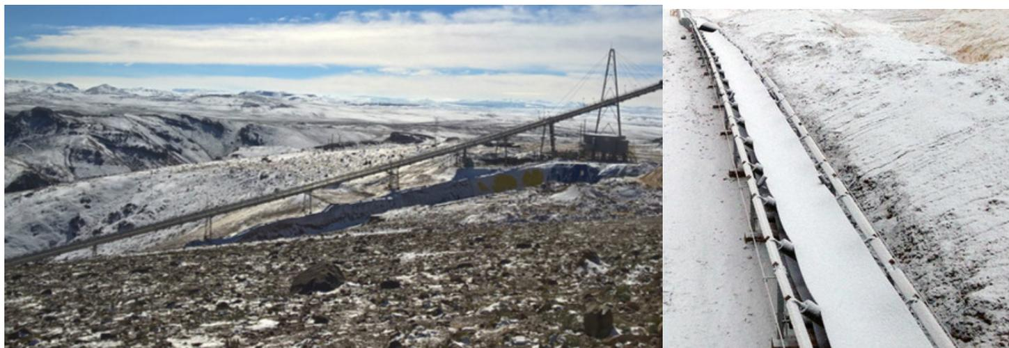
Esta cinta se fabrica con lienzo EP, lienzo de nylon o lienzo de algodón como carcasa, el caucho de la cubierta selecciona una mezcla de caucho natural y caucho de butadieno, que tiene propiedades de excelente elasticidad, resistencia a los golpes, resistencia al frío, etc. Puede funcionar normalmente en las condiciones de  $-60^{\circ}\text{C}$ .
