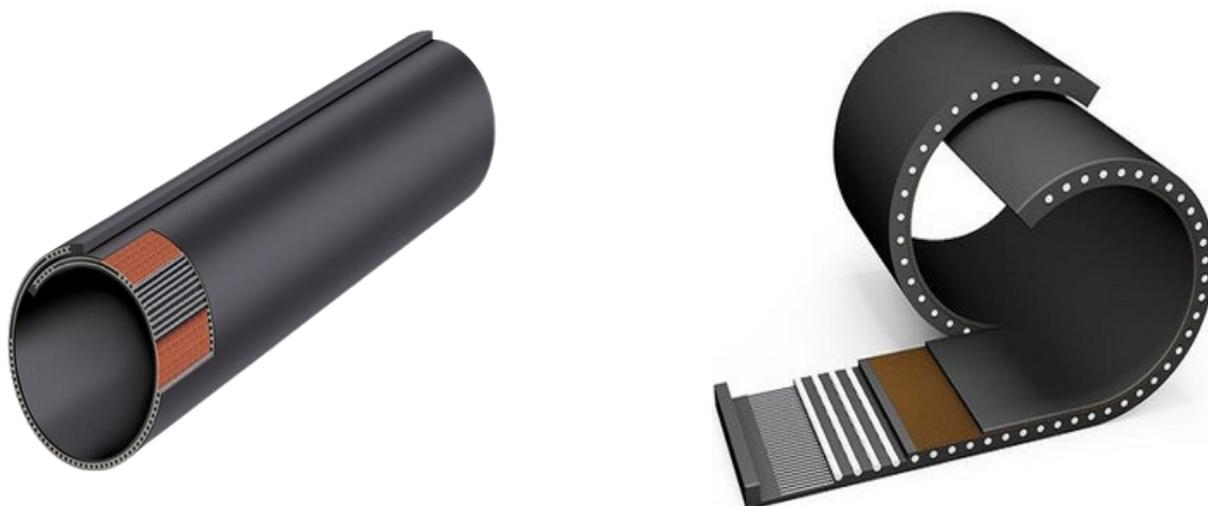
La cinta transportadora tubular esta compuesta por tela y cable de acero como estructura central y alta elasticidad, alta resistencia al desgaste y caucho de alta resistencia como superficie de trabajo.
