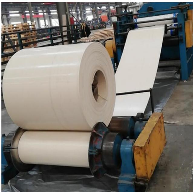
La cinta transportadora de calidad alimentaria se compone principalmente de caucho natural de alta resistencia al desgaste y una capa de tela de poliéster resistente al desgarro.
